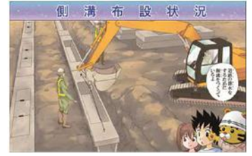
A-6 道路の排水をするために側溝をついているよ
