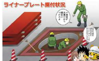
E-6 安全に工事を進めるためにライナープレートを取り付けているんだ
