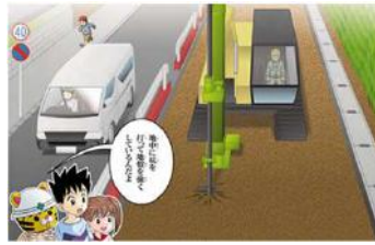
A-2 地中に杭を打って地盤を強くしているんだよ
